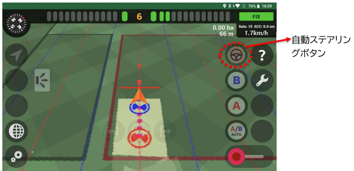
4. AgriBus-NAVI画面上の自動ステアリングボタンを長押しする、もしくはフットスイッチを踏むと自動操舵が開始されます。
